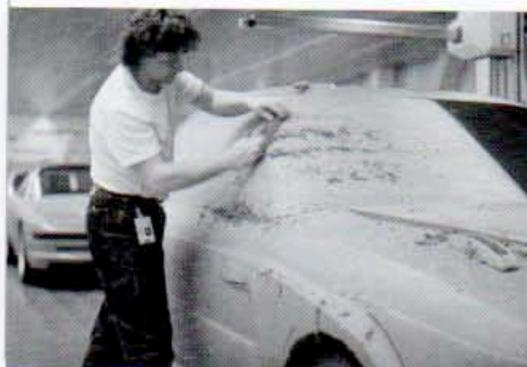
Un artisan travaillant sur la maquette en argile d'une voiture concept.
