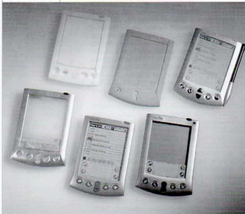
Le Palm V, des premiers prototypes en mousse et aluminium usiné au produit final avec un boîtier en aluminium estampé.
